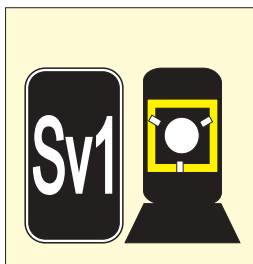
Výhybky se samovratným přestavňákem
