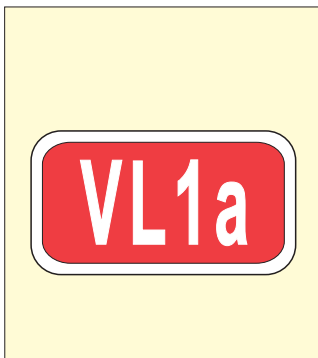
označovací štítek vloženého návěstidla
