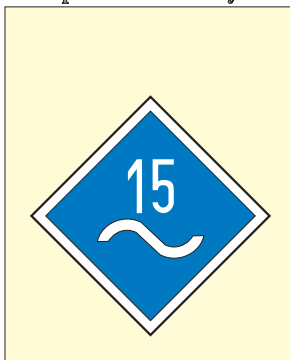
Začátek jednofázové trakční proudové soustavy
