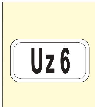
označovací štítek uzávěry koleje
