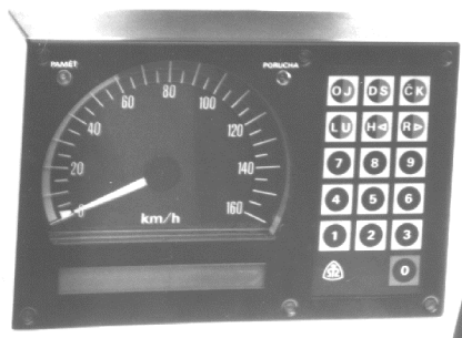
Zobrazovací jednotka LTZ s klávesnicí vedle stupnice rychlostí
